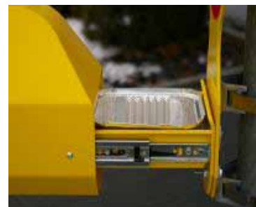
Der „Gumkiller“ geöffnet. Zu sehen ist die für den Behälter hergestellten Alu-Schale.
